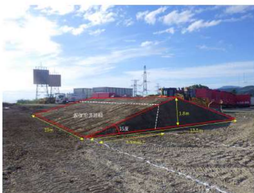
第3図 斜面崩壊後を模擬した土砂
