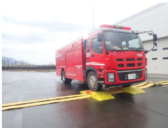
第1図 ホースブリッジの設置状況
