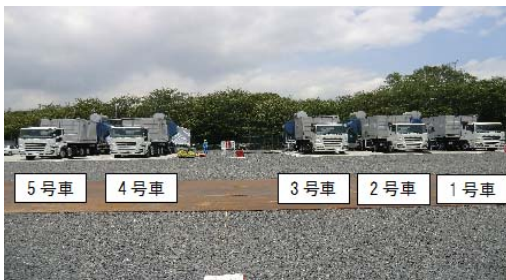
常設代替高圧電源装置（イメージ）
