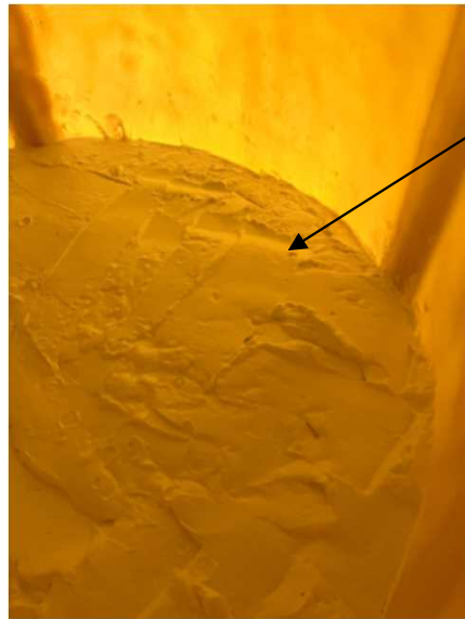
拔出し前のスラリーの状況 (上澄み水を抜き取り流動性が低い状態)
