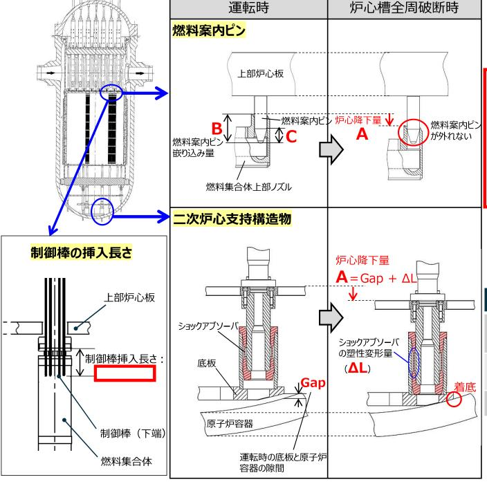
・炉心槽破断により下部炉心構造物が落下すると、二次炉心支持構造物の下端が原子炉容器下部鏡に着底し、炉心降下量が制限される。
