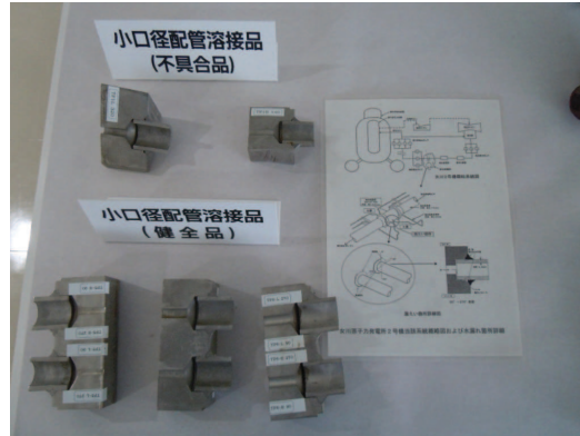
女川 2 号炉 給水流量計からの水漏れ
