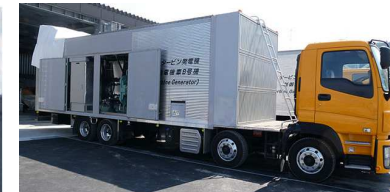
発電機車 出力3,600kW×2台
