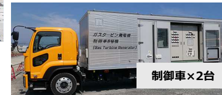
発電機車 出力3,600kW×2台
