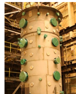
大型格納容器実験装置(CIGMA) シビアアクシデント時の格納容器内の熱水力現象を解明する
