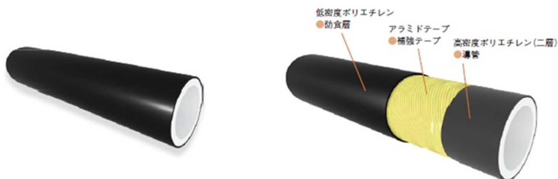
図 2.14.1.3-1 採用するポリエチレン管の構造イメージ
