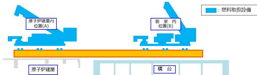
図 4.2.1-1 燃料取扱設備の位置
