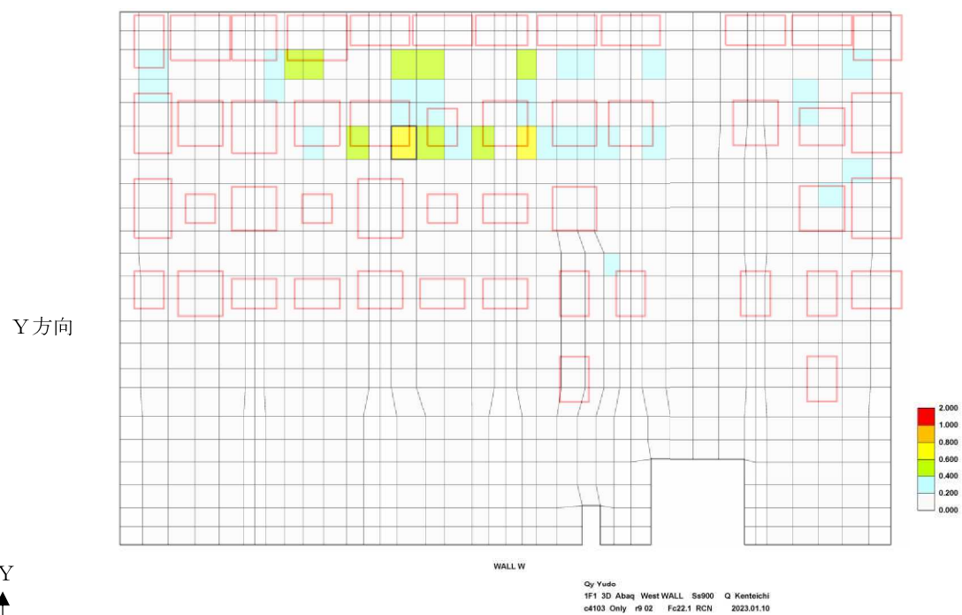
図-1.27 面外せん断力の検定比（建屋外壁西面）
