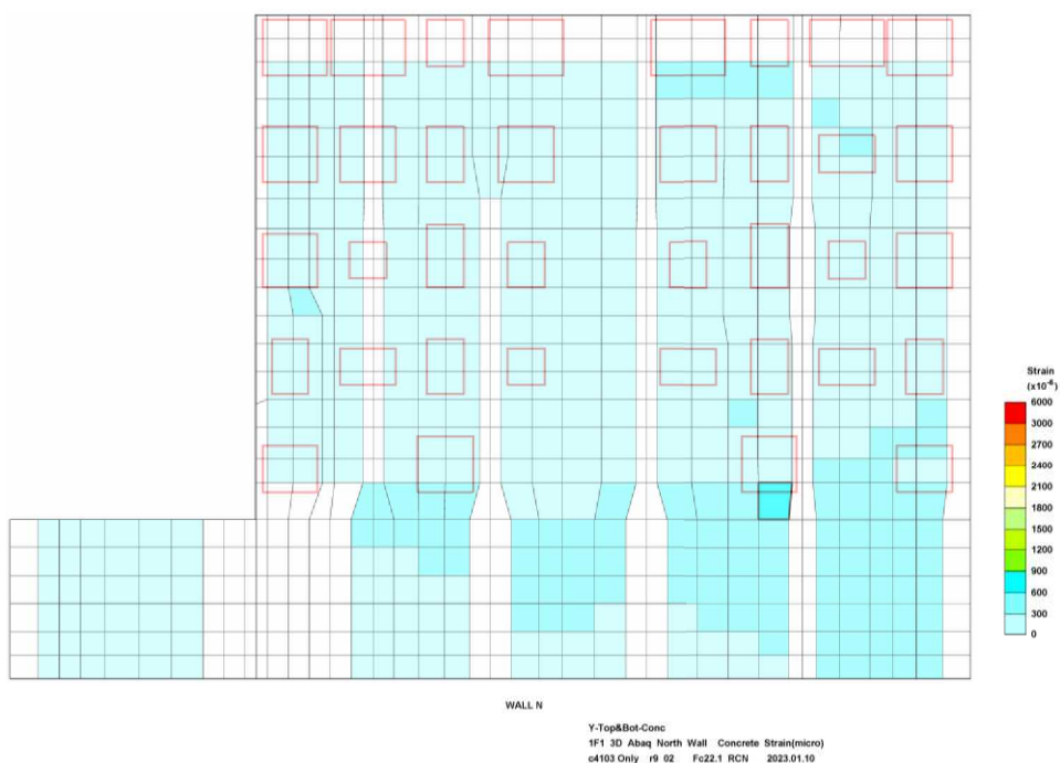
図-1.21 コンクリート圧縮ひずみの検定比 (建屋外壁北面)
