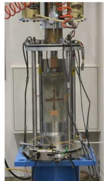
一軸圧縮試験の状況
