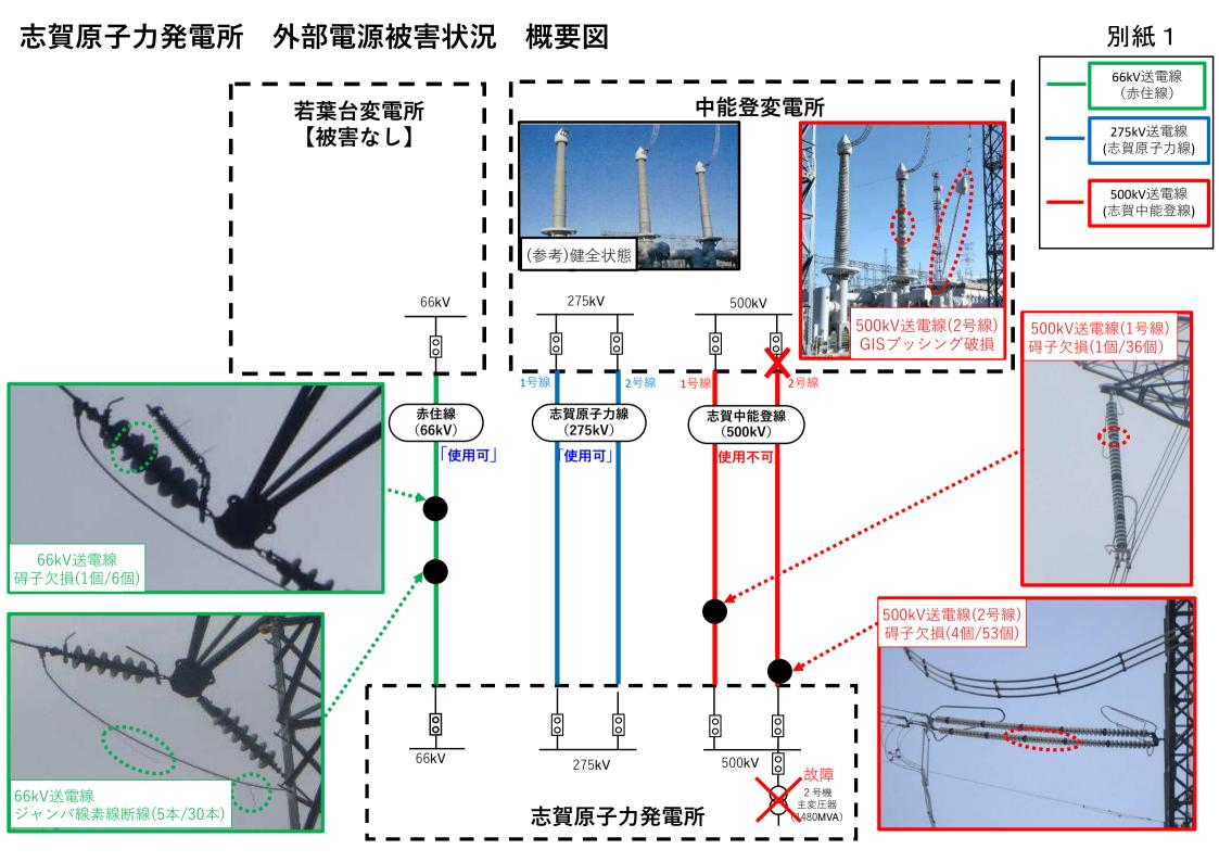
1号機:66kVより受電,2号機:275kVより受電(現在の受電状態)
