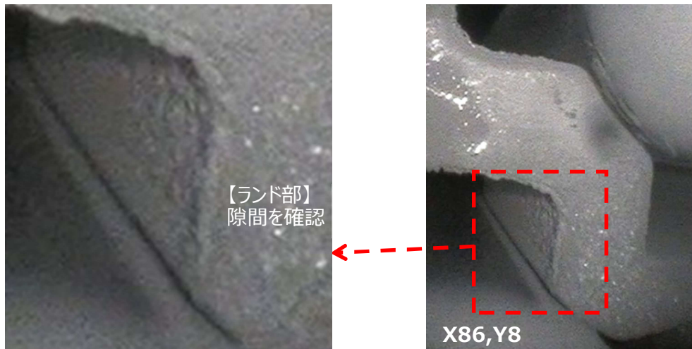
図3-11 伝熱管とランド部の隙間確認結果（C-SG：X86，Y8）
