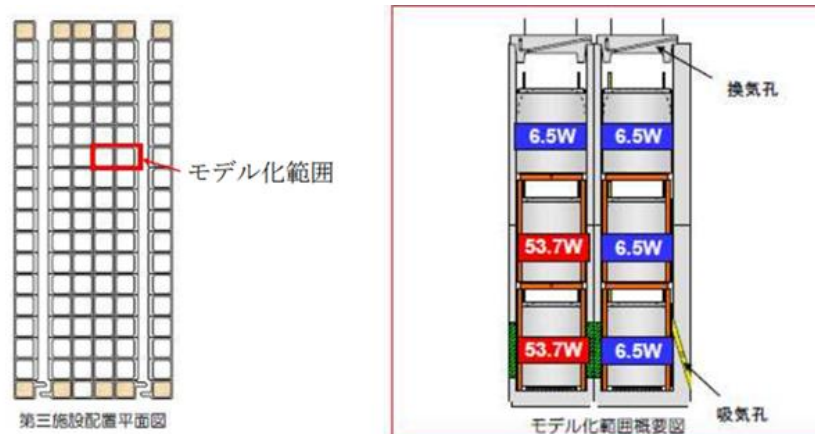
図 2.14.5-1 第三施設温度評価の評価体系概念
