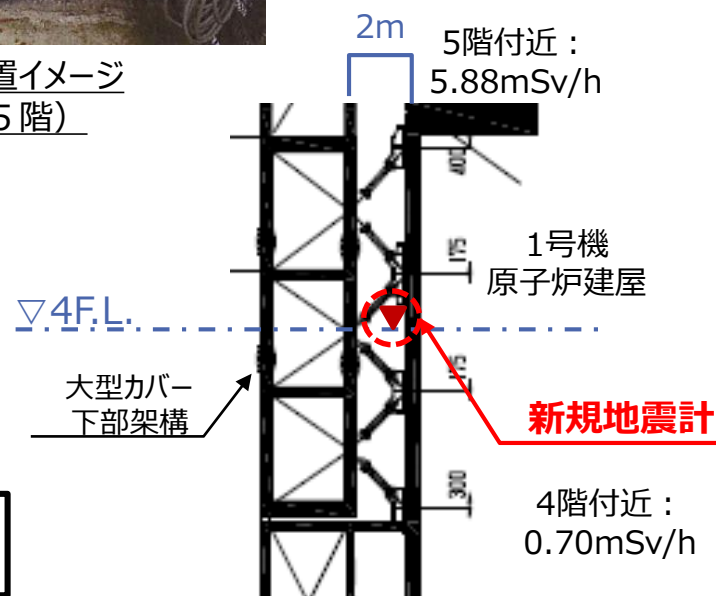
1号機原子炉建屋 西側断面図
