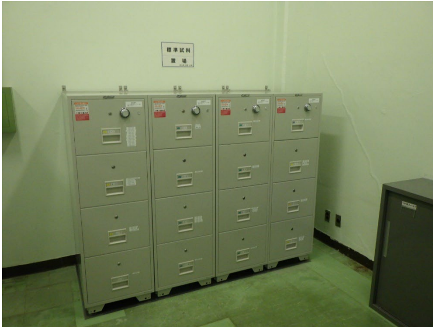
標準物質の保管棚※ 材質: 金属+気泡コンクリート
