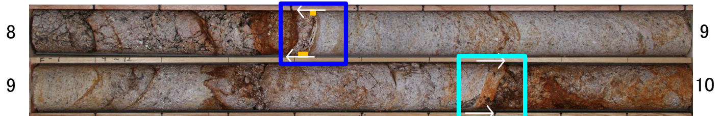
深度8.43~8.44mの連続性及び直線性が良い粘土
