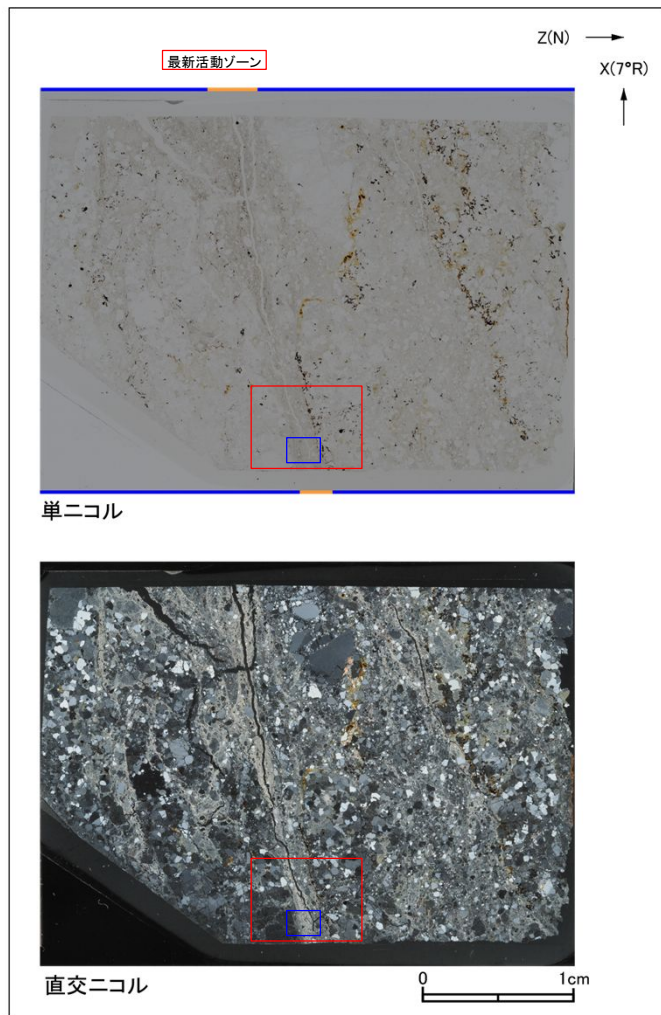
破線: 粘土鉱物の分布は帯状で直線的かつ連続的である
