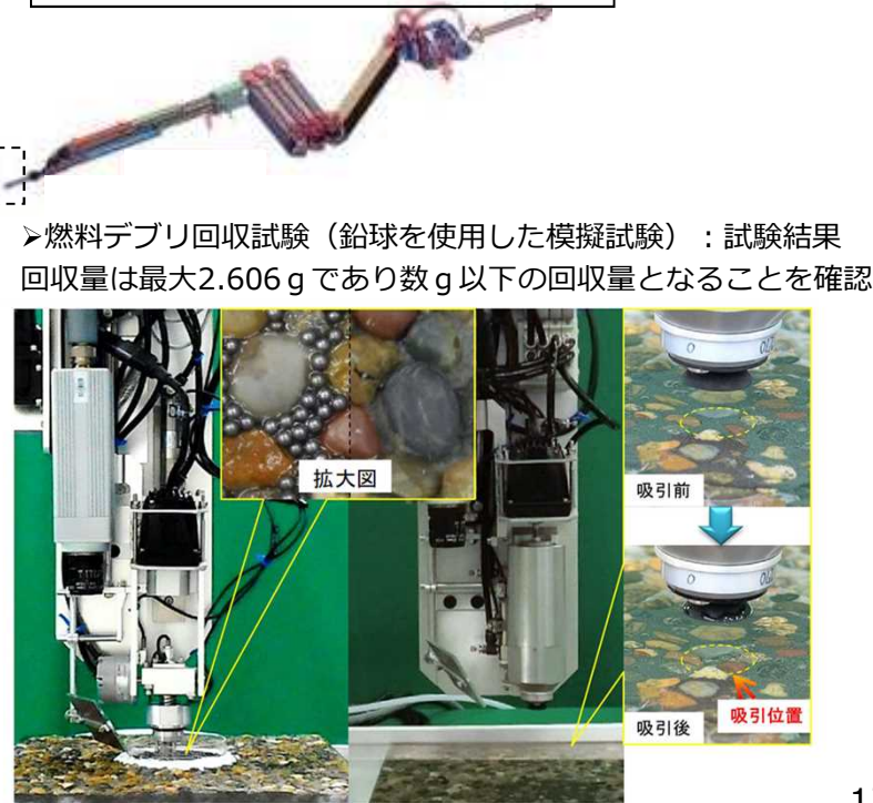
ロボットアームによるデブリ採取
