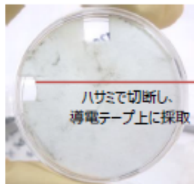
付着物 (スミア) 外観 SEM試料採取後
