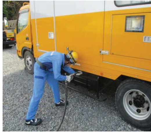
電源車への補給
