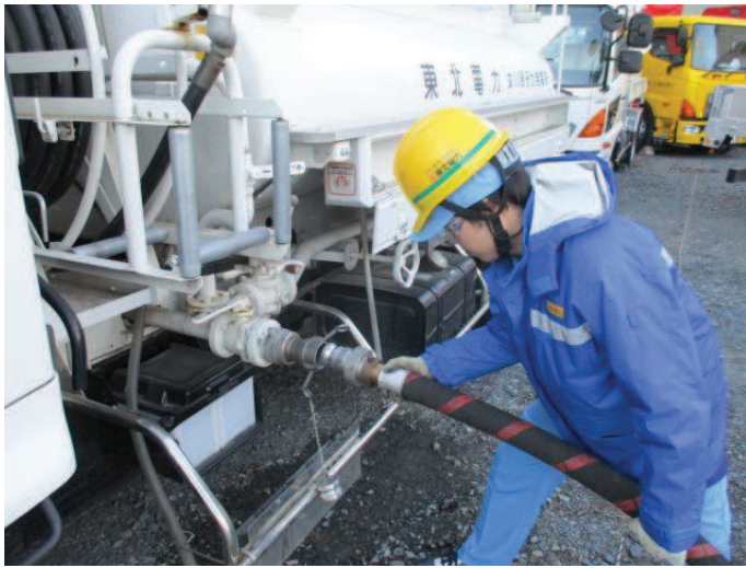
タンクローリへのホース接続
