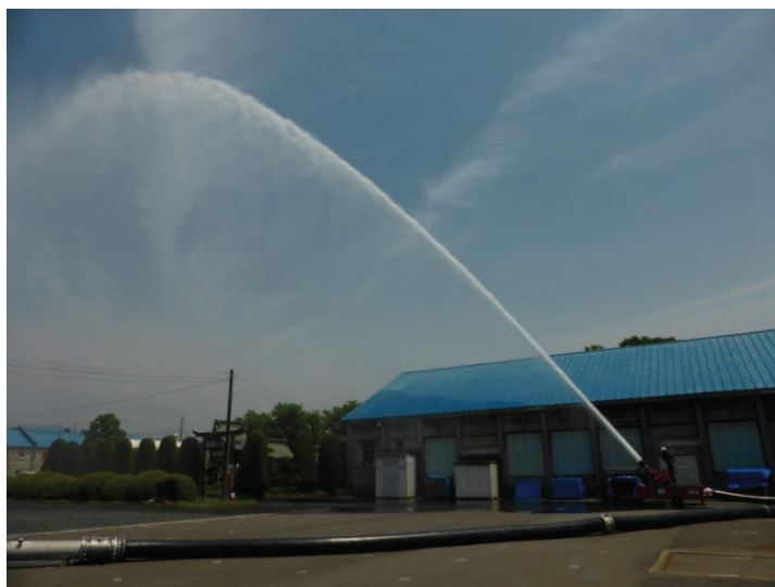
第9図 直状放射による放水
