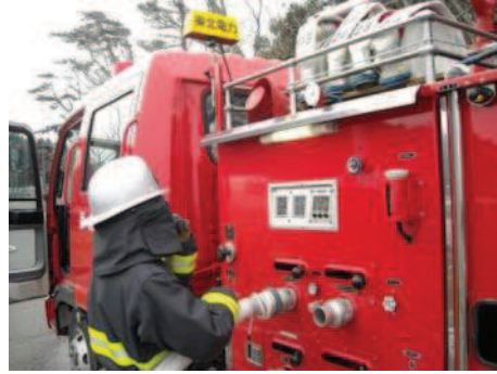
化学消防自動車へのホース接続
