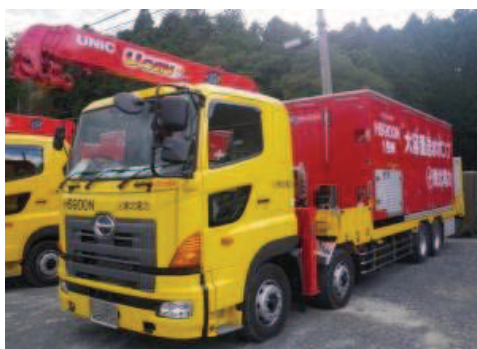
大容量送水ポンプ（タイプ I）
