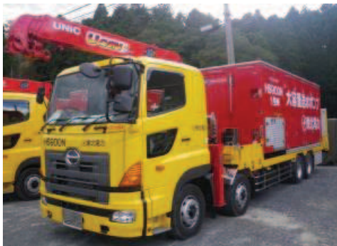
大容量送水ポンプ（タイプ I）
