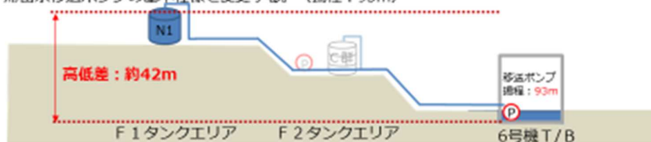
図1—11 5・6号機滞流滞留水移送設備概略図
