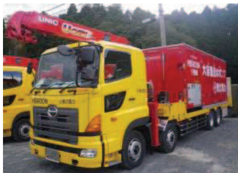
大容量送水ポンプ（タイプ I）
