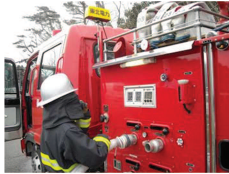
化学消防自動車へのホース接続
