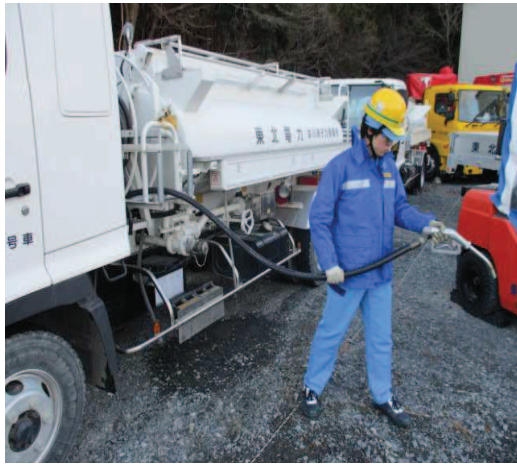
タンクローリから補給ホースの延長
