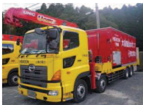
大容量送水ポンプ（タイプ I）
