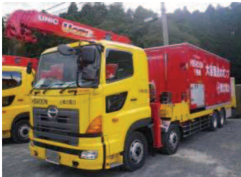
大容量送水ポンプ（タイプ I）
