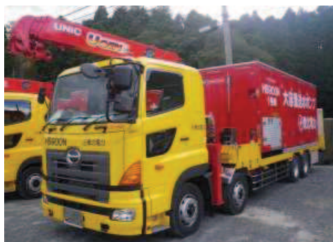
大容量送水ポンプ (タイプ I)
