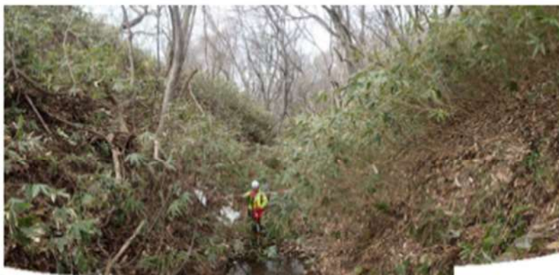
P3 防災科研調査において地滑り土塊末端部とされる箇所の状況 沢を挟んだ両岸において斜面の角度が同程度であり、地滑り土塊末端部を示唆する先端部の押し出しは認められない。
