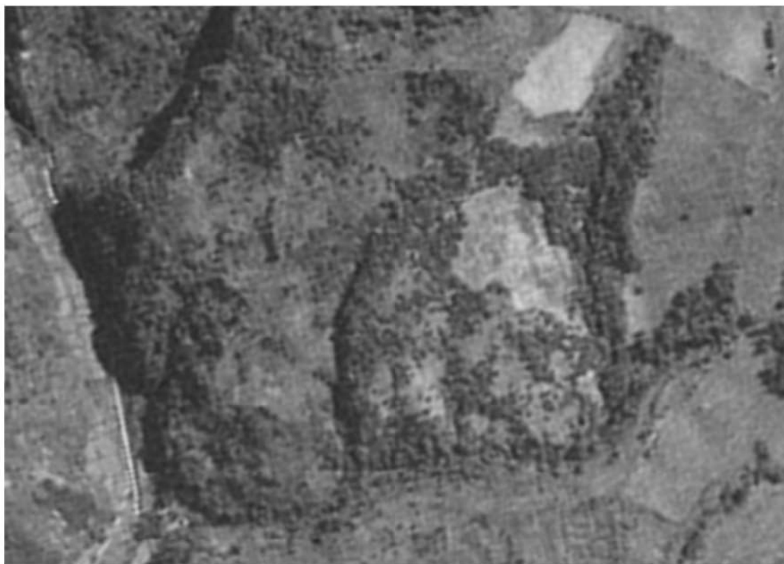
参考図6-2 防災科研調査が判読に用いた地滑り地形②周辺の空中写真 (撮影縮尺 4 万分の 1, 1965年撮影)
