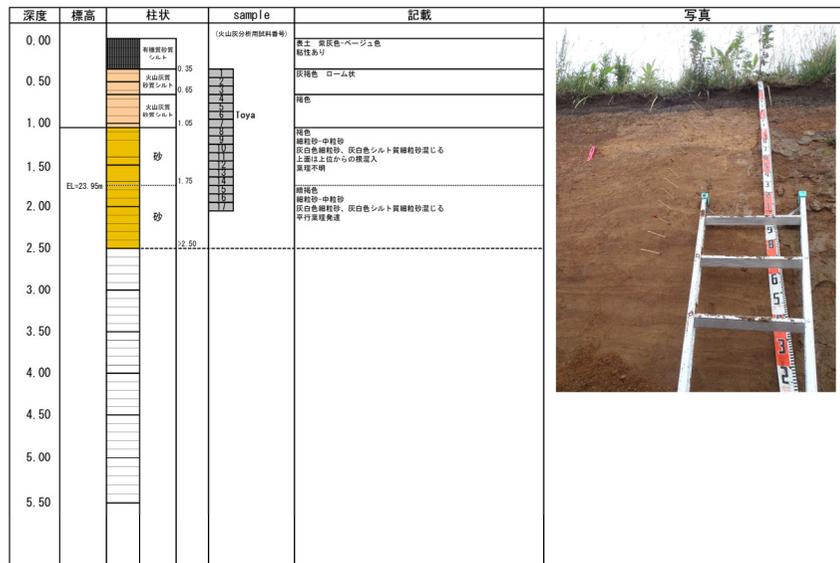
火山灰分析試料採取箇所① 露頭柱状図
