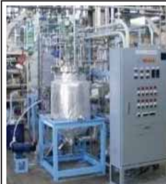
硝酸根分解試験装置 (1/25スケール)
