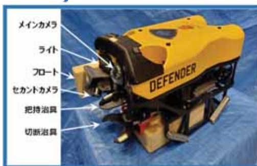
水中ROV (切断治具, 把持治具装備)
