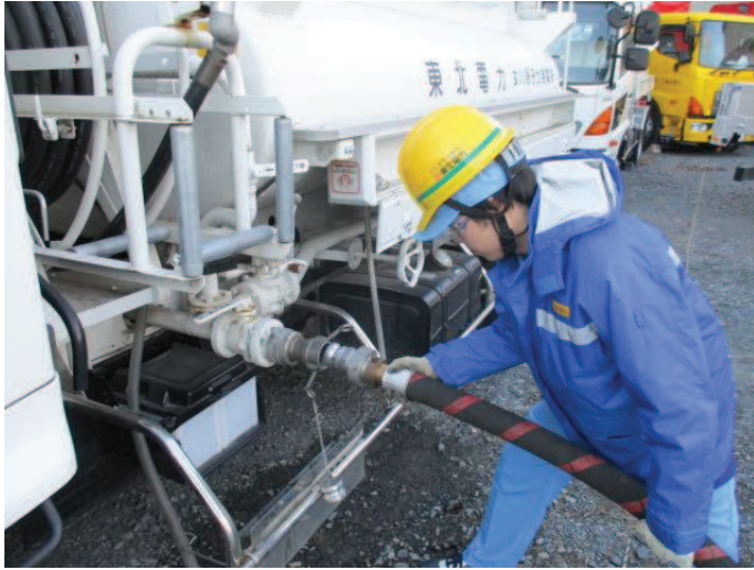
タンクローリへのホース接続
