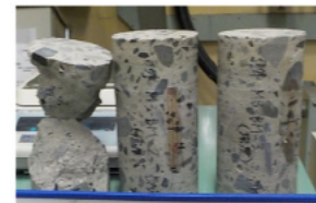
大きく破壊されたコアサンプル(左端) (例)
