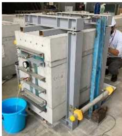
写真1 加圧試験状況
