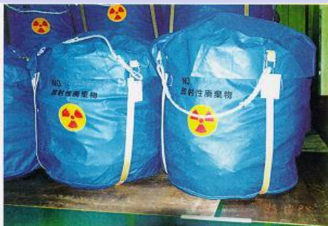
フレキシブルコンテナ(ポリエステル製)に収納したコンクリート廃棄物
