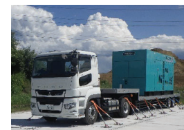
移動式発電機
