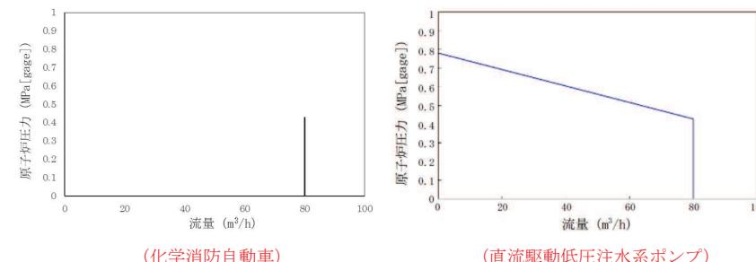
第 57-7-1-4 図 化学消防自動車及び直流駆動低圧注水系ポンプの注水特性
