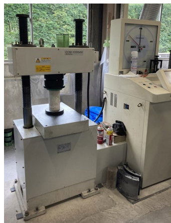
固化体を設置
