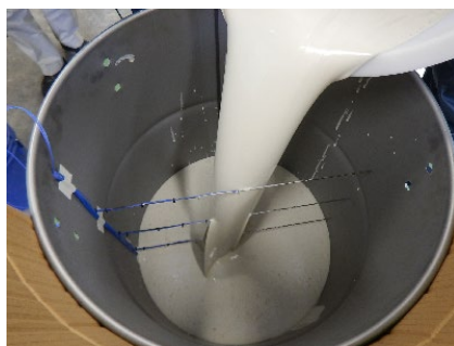
ドラム缶にM+BFS+CSを打設。極めて高流動。 (熱電対に当たって液流が分離するほど流動性が高い。)
