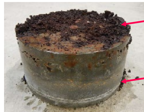
塊状ISの沈殿
