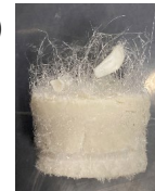
←AAMの白華現象(写真:例)。 \text{Na}_2\text{CO}_3 を主成分とする結晶が固化体から析出。
