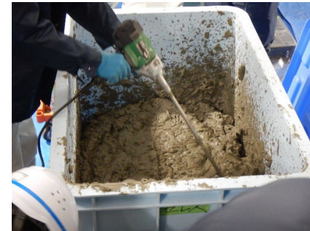
混練開始から 15分 。 流動性確保のため、水3Lを追加*、練り返し。大型コンテナ内で均一化。硬化が進行。
