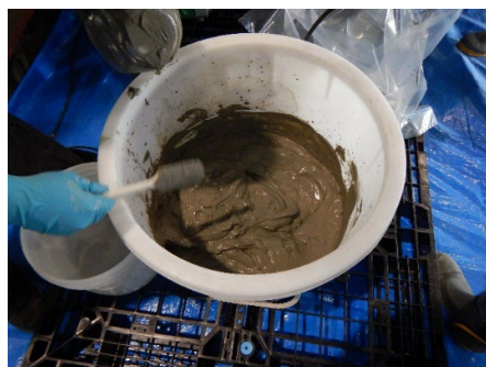
混練開始から 7分 。 凝結が始まり急結。
