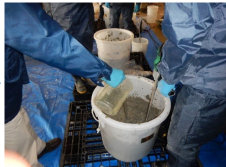
混練開始から 15分 。 流動性確保のため、水3Lを追加*、練り返し。大型コンテナ内で均一化。硬化が進行。
