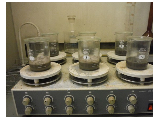
塩分浸透の点検状況 (塩化物イオンの抽出状況)
