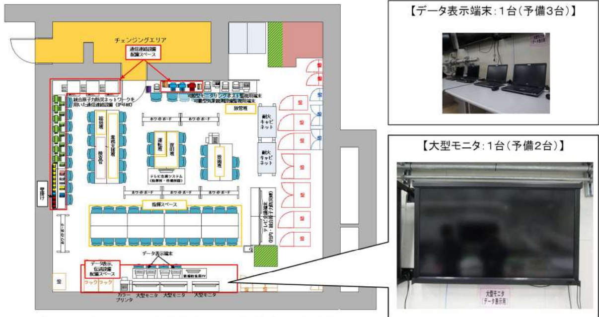
参考第 5-1 図 緊急時対策所における SPDS パラメータ表示の概要
