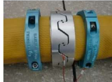
可搬型ホース（150A）接続後
