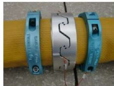
可搬型ホース（150A）接続後
