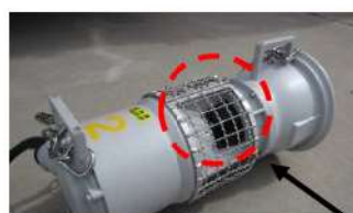
①水中ポンプの吸込み部
