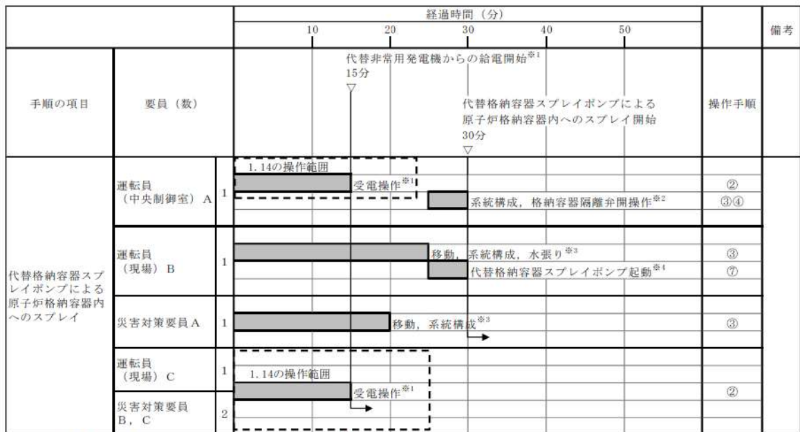
図 2.7-8 全交流動力電源喪失又は原子炉補機冷却機能喪失時の代替格納容器スプレイポンプによる原子炉格納容器内へのスプレイ タイムチャート ※2
