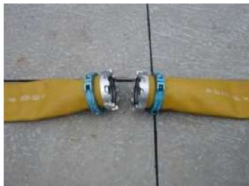
可搬型ホース(150A)接続前
