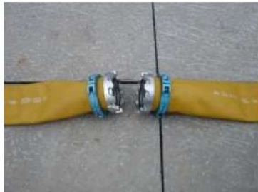
可搬型ホース(150A)接続前
