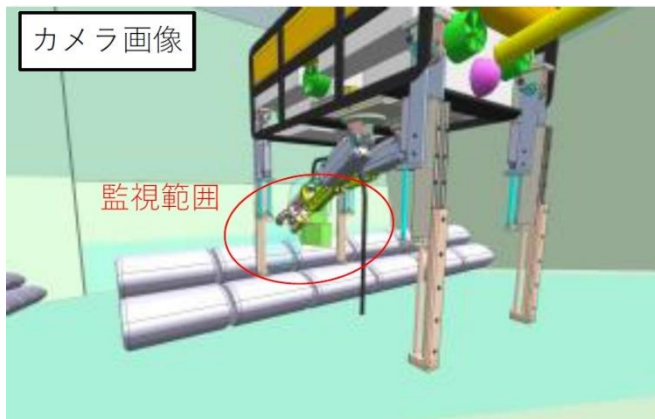
図 2.14.8.1-15 濁水中における水中の作業 環境近傍確認の概要
