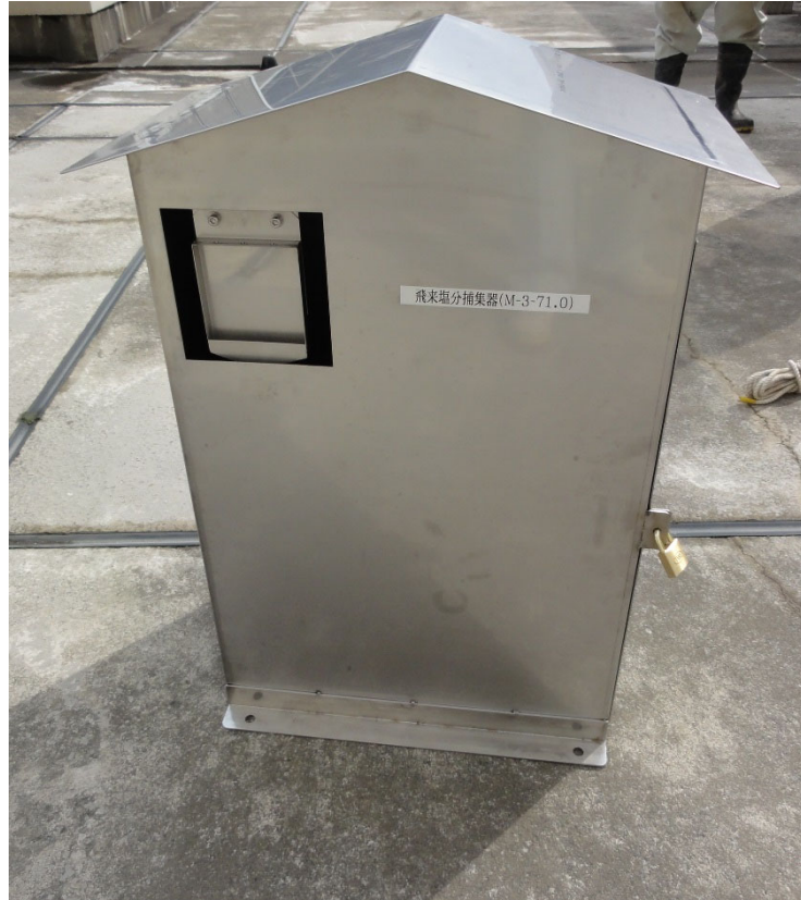
図4. 1. 4-1 飛来塩分捕集器 (土研式塩分捕集器)
