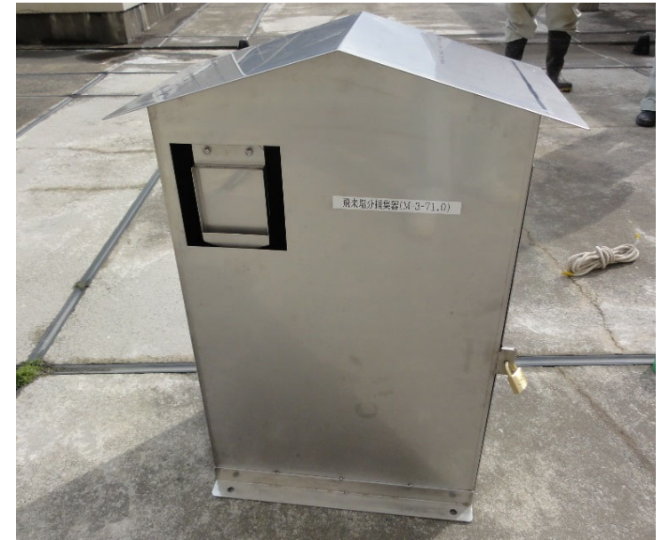
飛来塩分捕集器(土研式塩分捕集器)
