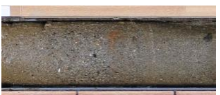
写真② M1 段丘堆積物は境界付近では10~15cm間隔で、細砂と礫混じり細砂が互層する。
