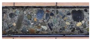
写真④ 東茨城層群の砂礫層。径5~30mmの亜円~円礫を主体とする。
