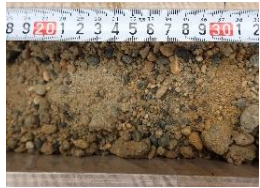
写真② M1 段丘堆積物(礫まじり砂)。径2~4mmの礫が砂層中に見られる。
