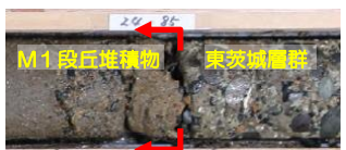
写真③ M1 段丘堆積物 (細砂、礫混じり砂との互層) と東茨城層群 (砂礫) の境界付近。
