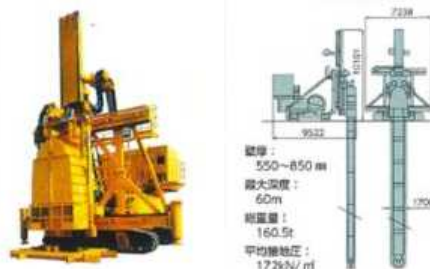
地盤改良(セメント改良土等)
