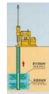
地盤注入(薬液等)
