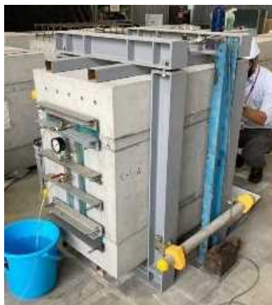
写真1 加圧試験状況
