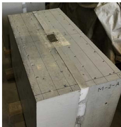
手順5：止水材（モルタル）注入完了
