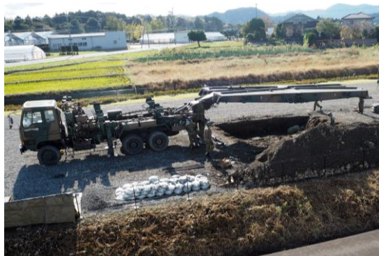
自衛隊設置架橋（81式自走架橋柱）
