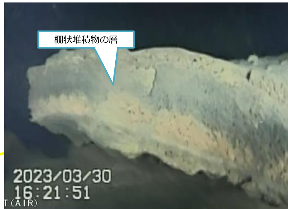
写真1. ペDESTAL外棚状堆積物断面
