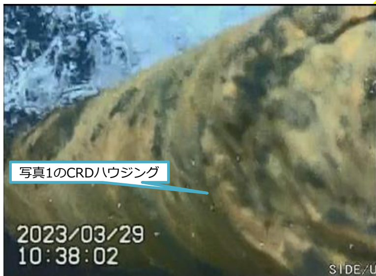
写真2 CRDハウジング断面
