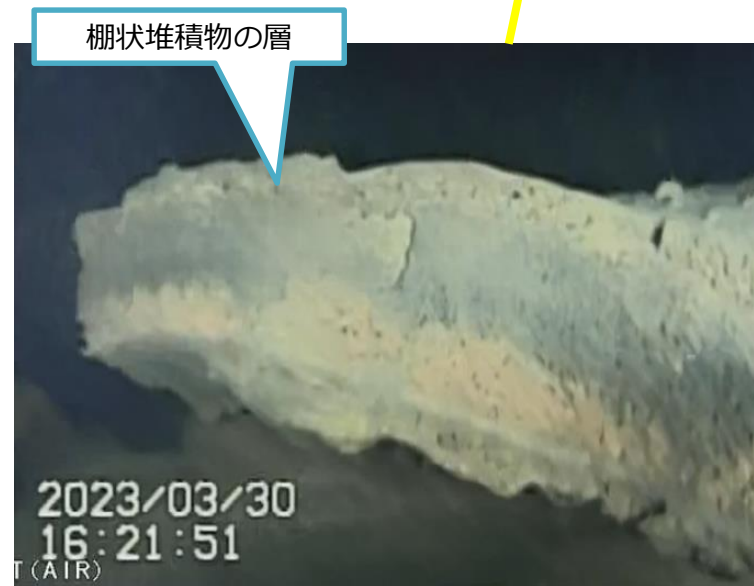
写真3. ペDESTAL外棚状堆積物断面
