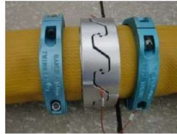
可搬型ホース（150A）接続後
