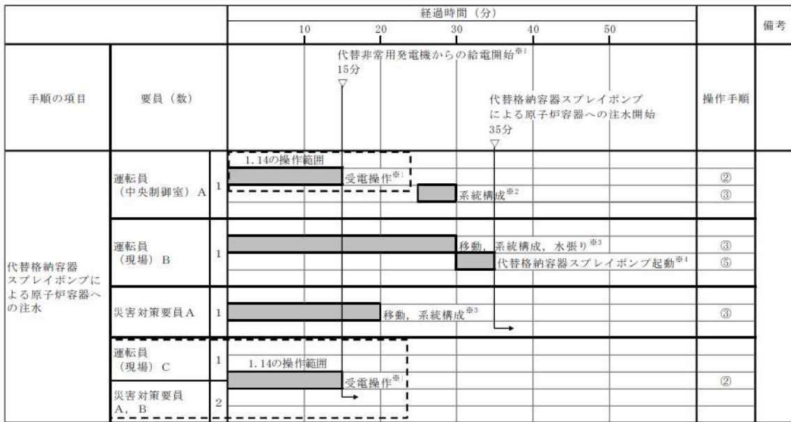
図 2.4-2 代替炉心注水 (代替格納容器スプレイポンプ) のタイムチャート (フロント系故障時) ※
