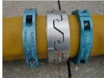
可搬型ホース（150A）接続後
