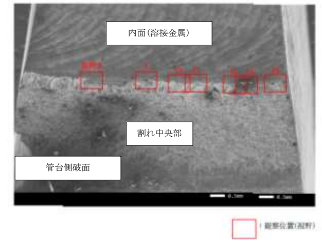
当該管 (T-2-2) の破面SEM (傾斜40°：管台側)
